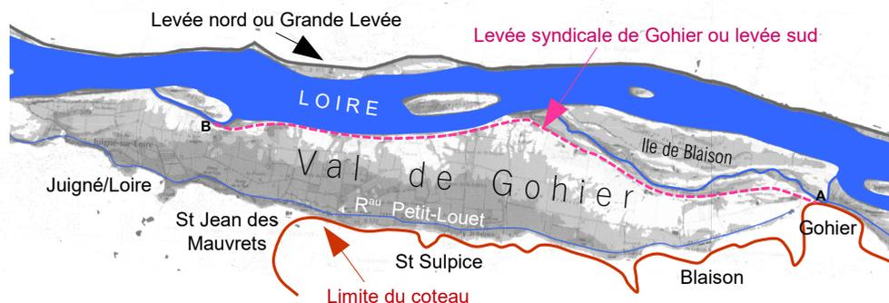
Il s'agit là, selon la DREAL, que de crues moyennes. La levée (A-B) est visible en blanc (repérée par des tirets) car non submergée. De même pour la bordure de l'île le long de la Loire, montrant ainsi nettement la ligne de « bourrelets » d'alluvions sur la rive.
